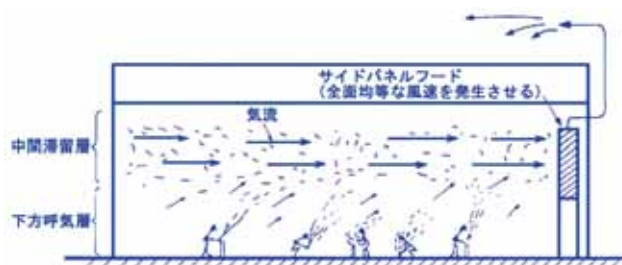
平行層流排気方式による全体換気の例
