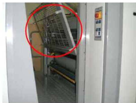
図 2-8 機械内部の可動ガード
