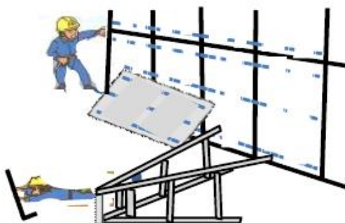
脚立からの墜落・転落
