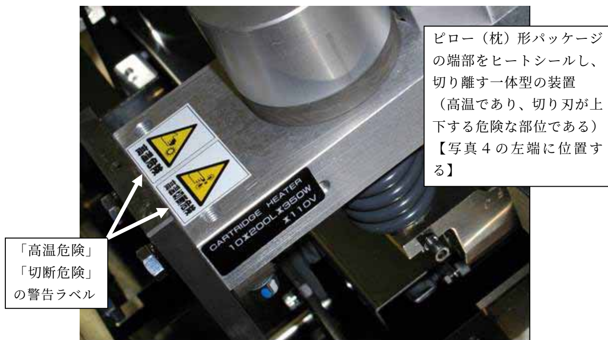
写真３ 残留リスク情報（危険部位への警告ラベルの貼付）
