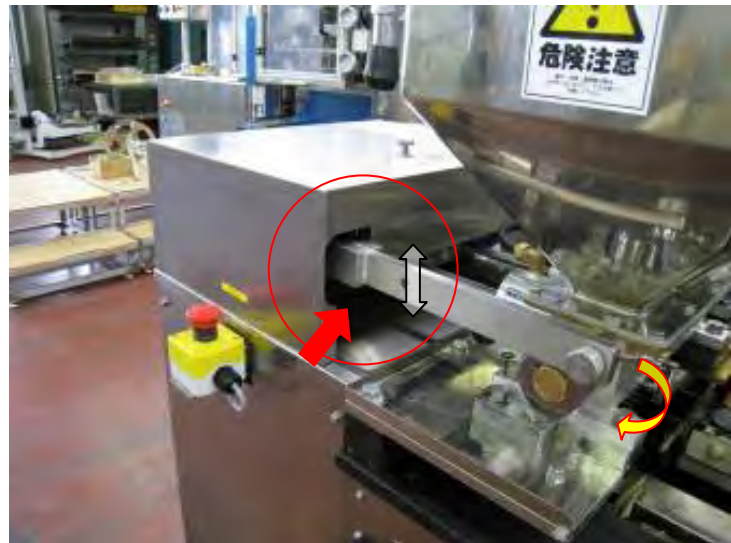
図 16. 可動ガードの危険源
