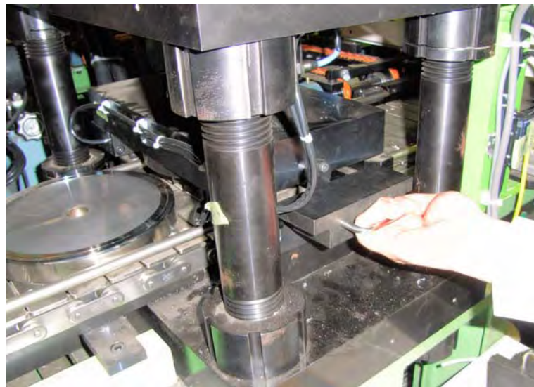
写真 2 一次成型プレス機構
