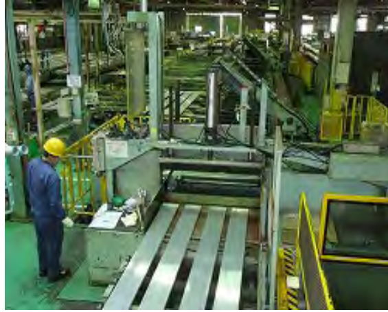
⑥ 後面設備（製品切断機-2）
