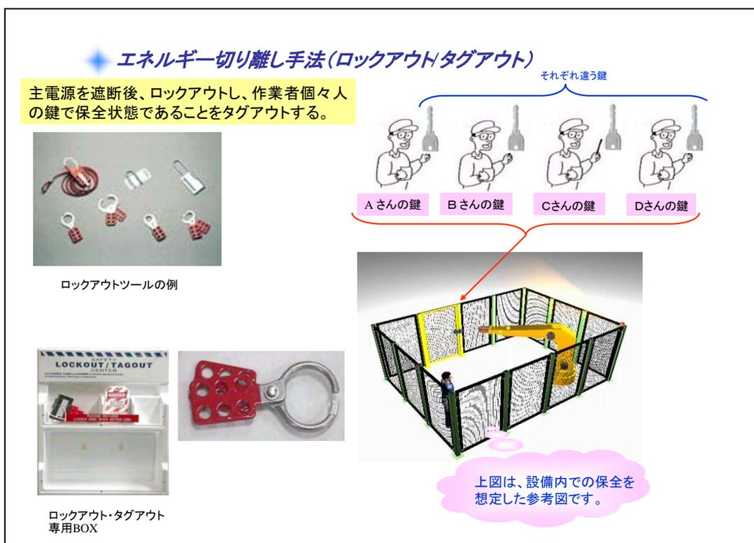
図23：エネルギー切り離し手法(ロックアウト/タグアウト)
