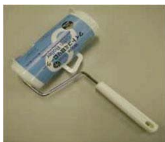
図 6.5.2. 床表面のダニ採取方法 （粘着クリーナー法）
