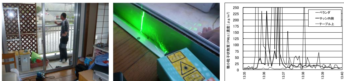
図 5.4.3. ベランダで喫煙した際のリビングの汚染（受動喫煙）と煙の流入経路
